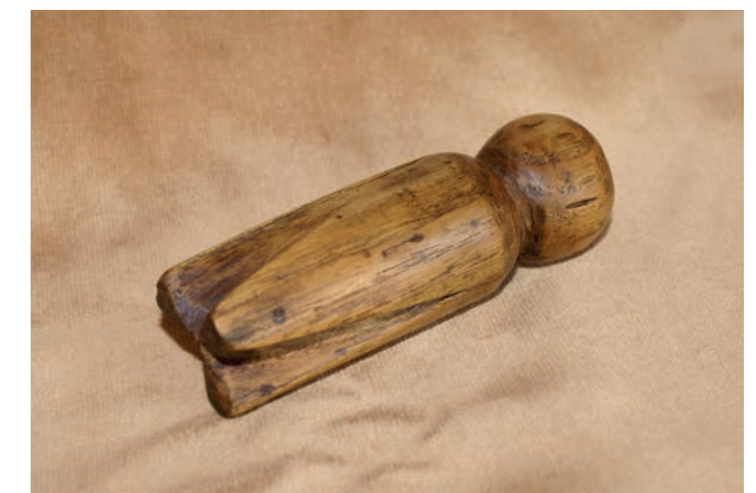
Spleethoutje. Afmetingen: diameter 3,1 cm, lengte 9,5 cm. Foto: auteur.
