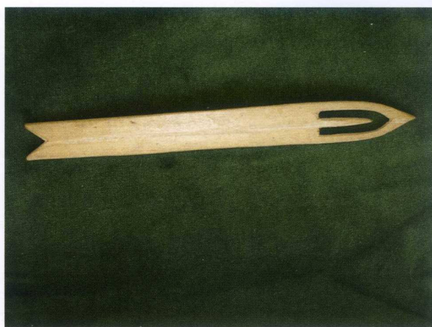
Zelfvervaardigde boetnaald van hout (22 x 2,3 cm). Foto: Jan Huizing
